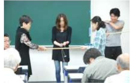
摩擦の実験、棒に紐を巻いて引っ張る、一巻きくらいでは簡単に外れてしまうが、5回くらい巻くと全く動かなくなる。
